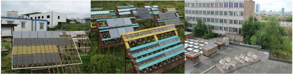
Рисунок 55 – Примеры коррозионных станций РАН для натуральных климатических испытаний в г. Владивостоке, д. Дунино (Московская область) и г. Москве
